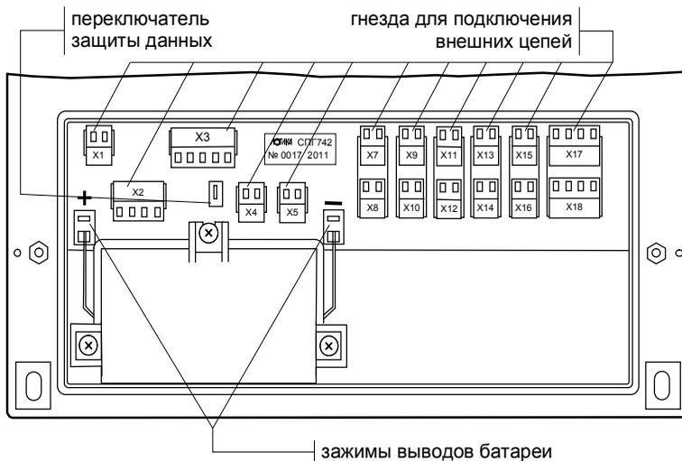
Рисунок 3.2 – Монтажный отсек
